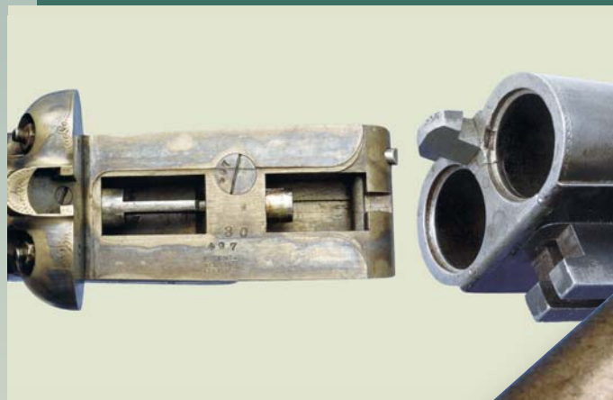
Илл. 16. Элементы верхнего и нижнего скрепления коробки и стволов у М 1878 и М 1879
