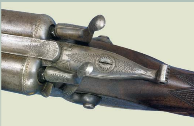
Илл. 15. Конфигурация коробки и форма рычага М1875
