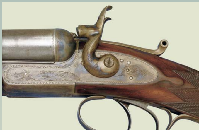
Илл. 17а. Образец плоскорельефной гравировки на левой замочной доске ружья с верхним поднимающимся рычагом (М1879, градация 5)
