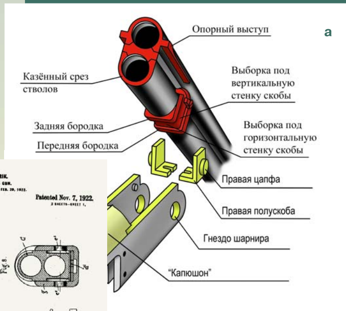
Илл. 27. Лист спецификации к патенту Б. Петрика, один из вариантов подвески стволов «в люльке» (а) и рисунок, поясняющий схему разгрузки шарнира (б) в бокфлинте фирмы «Дамон».
